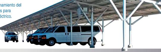
Tipo de aplicación: Permite techar grandes espacios, cuenta con 2 soluciones de cimentación (dado de concreto o tornillos de tierra). Material: aluminio grado estructural 6005 T6, tornillería y accesorios en acero inoxidable 304.
